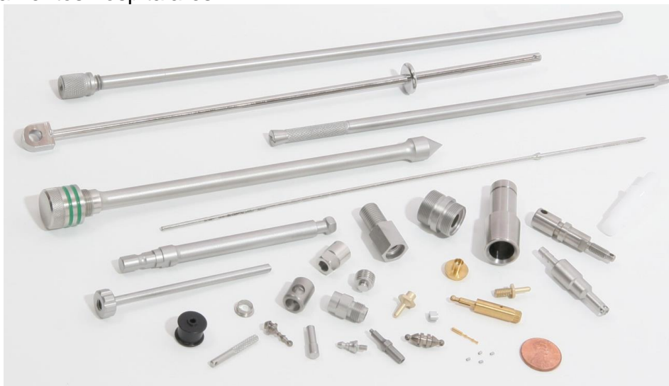
Figura 2 - Peças produzidas por usinagem de barras para aplicação em montagem de equipamentos hospitalares.
