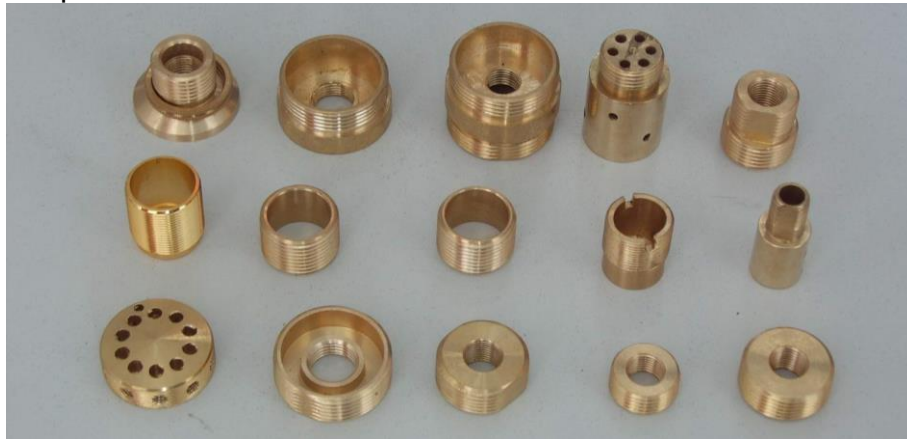
Figura 1 - Peças produzidas por usinagem de barras de latão, para aplicação em montagem de produtos sanitários.
