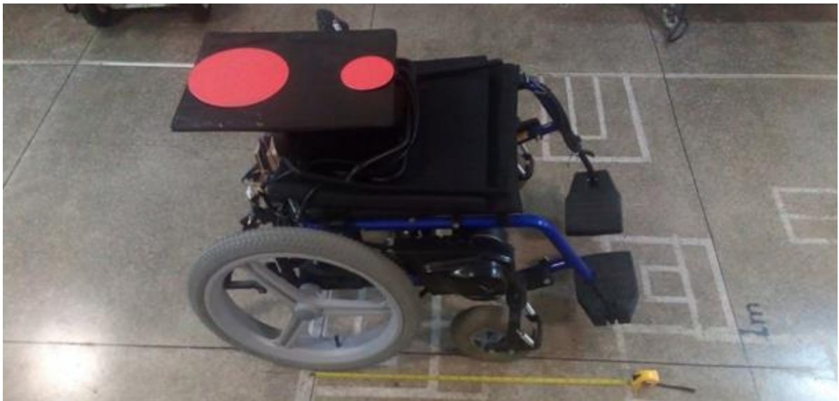
Figura 30 - Posicionamento da placa de localização posicionada na cadeira de rodas robótica
